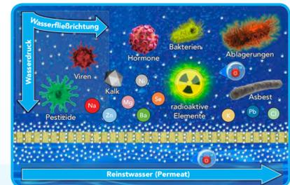
Das bedeutet, eine fremdstoffhaltige Lösung wird auf die Membran gepresst, die jedoch nur für Wassermoleküle durchlässig ist. Während also die nicht durchgängigen, im Wasser gelösten Stoffe zurückgehalten werden, sammelt sich auf der gegenüberliegenden Seite der Membran nahezu vollständig sauberes Wasser.
